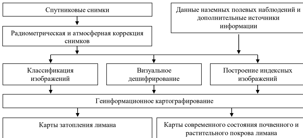
Рисунок 1 – Схема проведения картографирования состояния и использования земель лиманного орошения с использованием данных ДЗЗ
